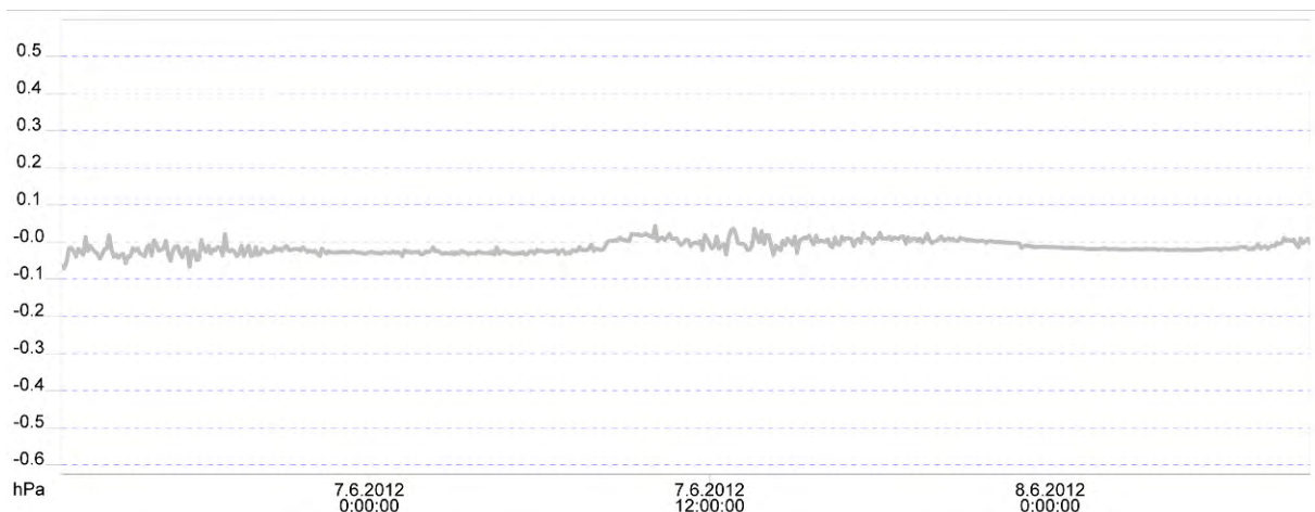
Kaavio 6. CO 2 +T+RH+PE.03–OT4 64. Huonetilan OT4 64 paine-ero suhteessa ulkoilmaan ajanjaksona 6.6. (klo 13.10) - 8.6.2012 (klo 10.10). Huonetila oli mittausajankohtana lievästi alipaineinen suhteessa ulkoilmaan.
