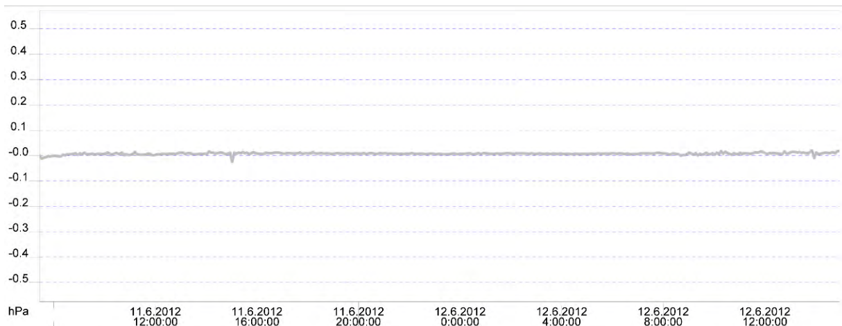
Kaavio 4. CO 2 +T+RH+PE.02–83 . Huonetilan OPE 183 paine-ero suhteessa alapuoliseen kellarikerrokseen ajanjaksona 11.6. (klo 7.27) - 12.6.2012 (klo 14.57). Paine-ero suhteessa alapuoliseen kellarikerrokseen oli mittausajankohtana tasapainossa.
