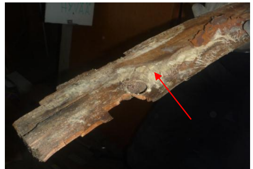
Kuva 34 Ullakkotilassa oli yksittäinen lauta, jossa oli viitteitä mikrobikasvustosta
