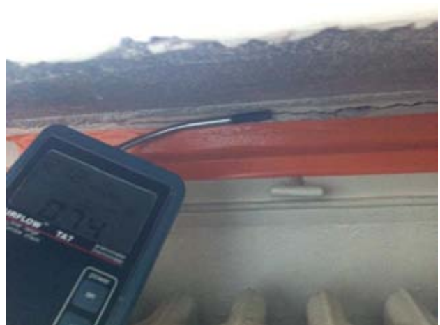
Kuvat 21 ja 22: Ilmanvuotoja ulkoseinän ja ikkunapenkin liitoksessa olevasta halkeamasta (7)
