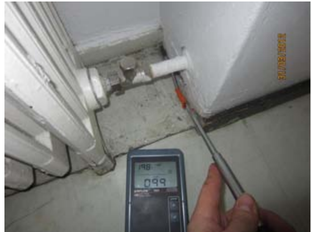
Kuvat 87-90: Ilmanvuotoja patterisyvennyksessä ulkoseinän ja välipohjan liitoksesta (29)
