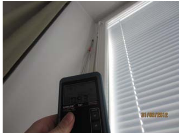
Kuvat 42-45: Ilmanvuotoja ikkunan karmin liitoksesta seinärakenteeseen (17)
