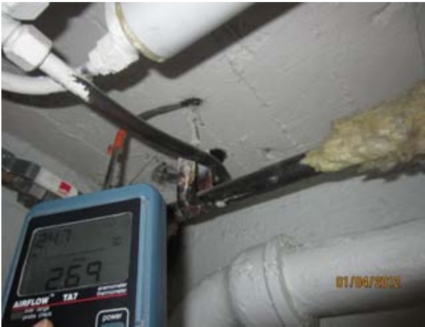
Kuvat 19-22: Ilmanvuotoja vesijohdon ja viemäriputken läpiviennistä sekä kannatinkoukun asennuspaikasta (6)
