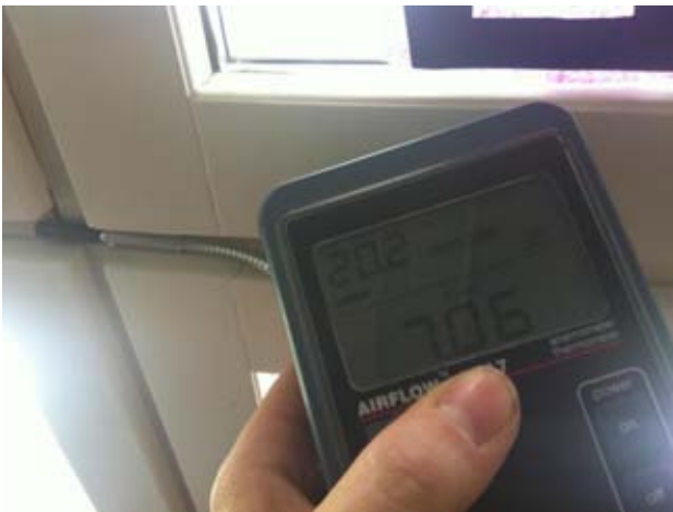
Kuvat 14-17: Ilmanvuotoja pysty- ja vaakavälialueen liitoksesta sekä karmin ja puitteen välistä (5)
