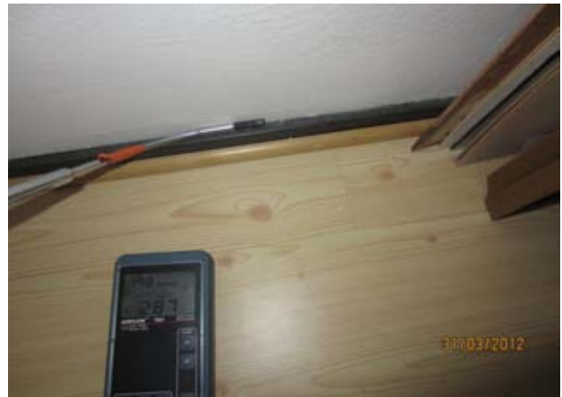
Kuvat 71 ja 72: Ilmanvuotoja ulkoseinän ja välipohjan liitoksesta, havaittu myös savun avulla (27)
