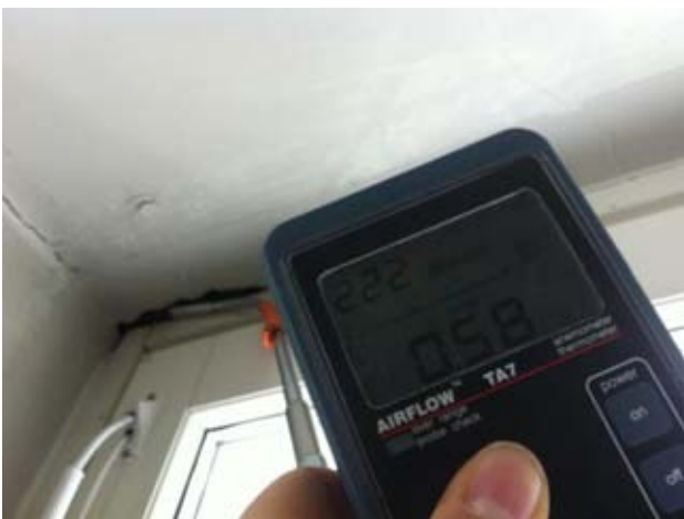
Kuvat 26-29: Ilmanvuotoja ikkunan karmin liitoksesta seinärakenteeseen (9)
