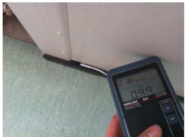
Kuvat 96 ja 97: Ilmanvuotoja ulkoseinän ja kellarin vastaisen välipohjan liitoksesta jalkalistan takaa (32)
