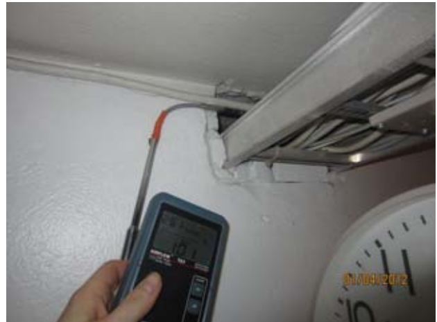
Kuvat 31 ja 32: Ilmanvuotoja WC:n vastaisessa seinässä olevasta läpiviennistä sähköjohtoja varten (10)
