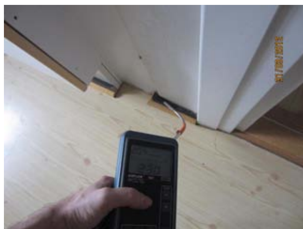
Kuvat 58 ja 59: Ilmanvuotoja johtajahuoneen vastaisen seinän ja lattiapäällysteen liitoksesta, havaittu myös savun avulla (21)
