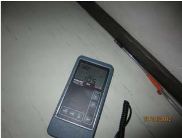
Kuvat 61-64: Laajoja ilmanvutoja päätyseinän ja välipohjan liitoksesta (21)
