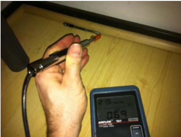
Kuvat 61-64: Ilmanvuotoja ulkoseinän ja lattiapäällysteen välistä jalkalistan takaa (20)
