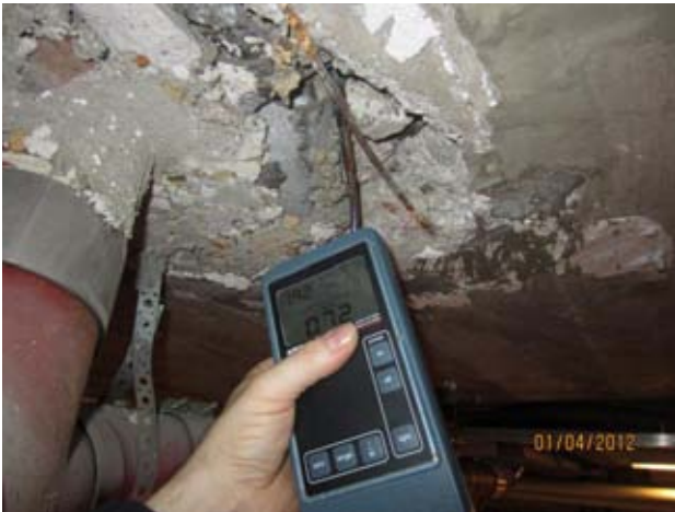
Kuvat 8-11: Ilmanvuotoja viemärin läpiviennin kohdalta (3)
