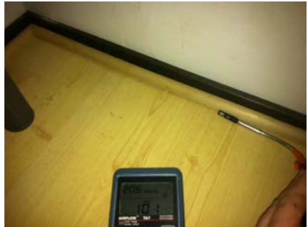
Kuvat 61-64: Ilmanvuotoja ulkoseinän ja lattiapäällysteen välistä jalkalistan takaa (20)
