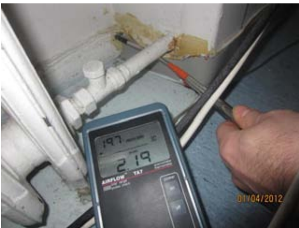
Kuvat 25-29: Ilmanvuotoja ulkoseinän ja välipohjan liitoksesta patterisyvennyksessä (9)
