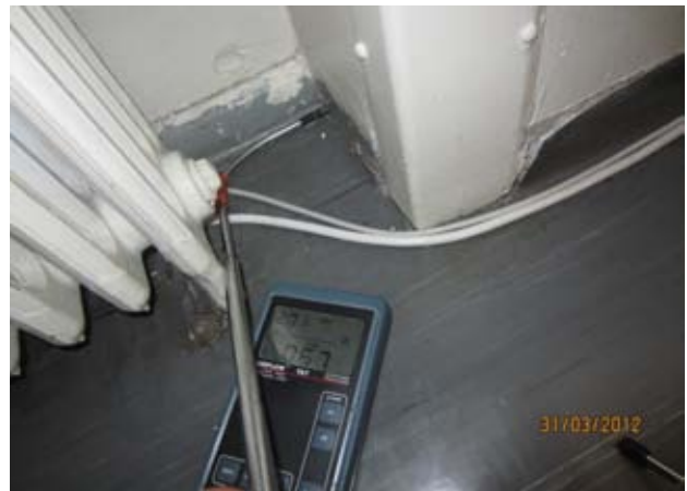
Kuvat 11 ja 12: Ilmanvuotoja ulkoseinän ja välipohjan liitoksesta patterisyvennyksessä (5)
