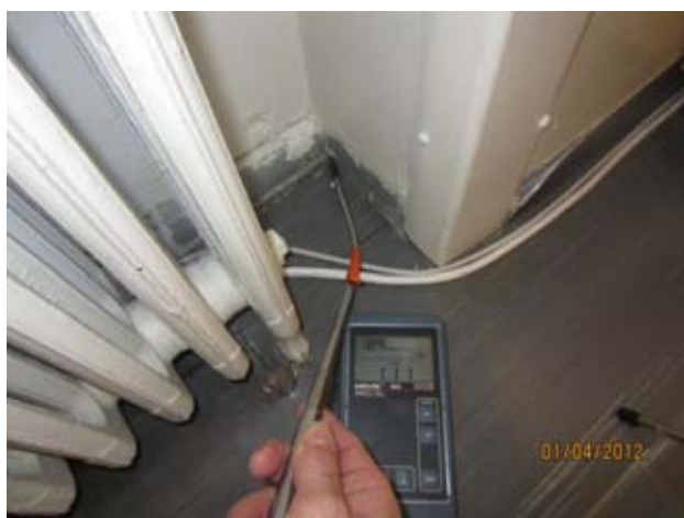
Kuvat 9-12: Ilmanvuotoja ulkoseinän ja välipohjan liitoksesta patterisyvennyksen kohdalla (4)
