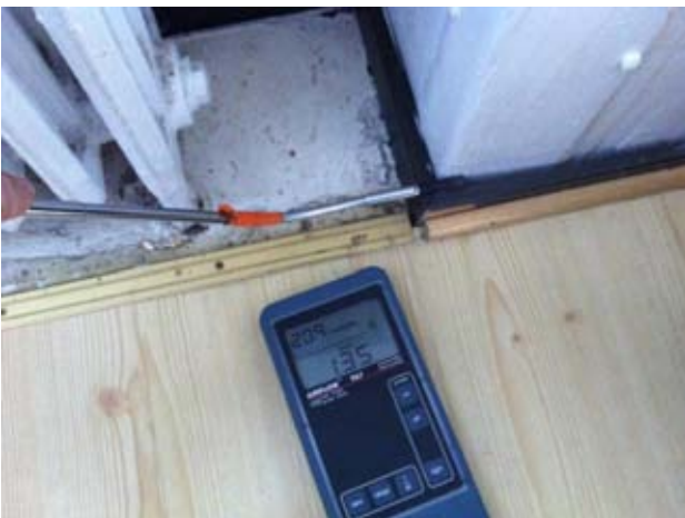
Kuvat 74-77: Ilmanvuotoja ulkoseinän liitoksesta kellarin vastaiseen välipohjaan jalkalistan takaa (24)
