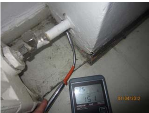
Kuvat 46-49: Ilmanvuotoja ulkoseinän ja välipohjan sekä ulkoseinän ja patterin vesiputken liitoksesta (16)
