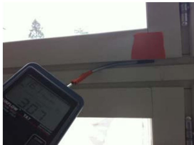
Kuvat 98-101: Ilmanvuoja ikkunaelementin karmin ja puitteiden välistä (33)
