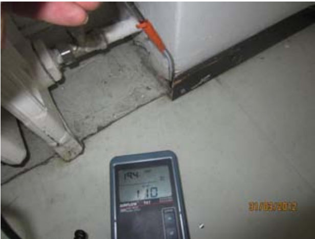
Kuvat 87-90: Ilmanvuotoja patterisyvennyksessä ulkoseinän ja välipohjan liitoksesta (29)
