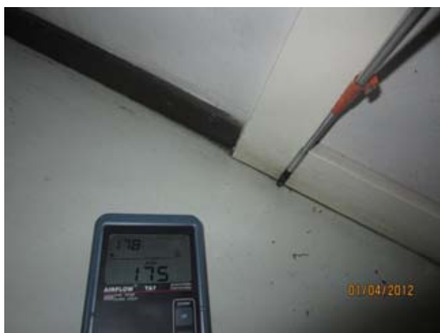
Kuvat 67-70: Ilmanvuotoja päätyseinän ja välipohjan liitoksesta (23)
