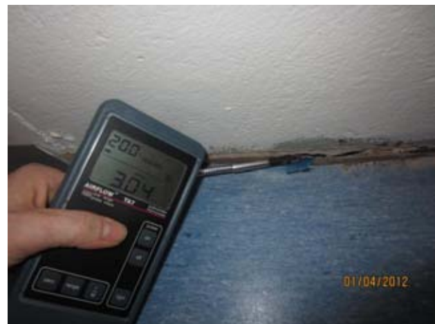
Kuvat 30-33: Ilmanvuotoja huoneiden välisen seinän ja välipohjan liitoksesta (10)
