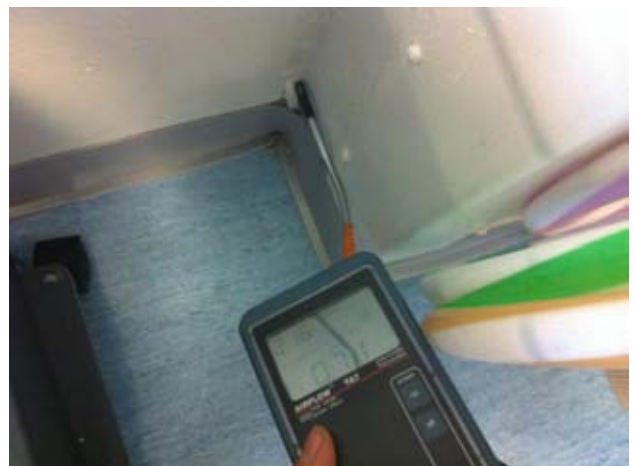
Kuvat 52 ja 53: Ilmanvuoja välipohjan ja seinien sisänurkan liitoksesta, havaittu myös savun avulla (18)
