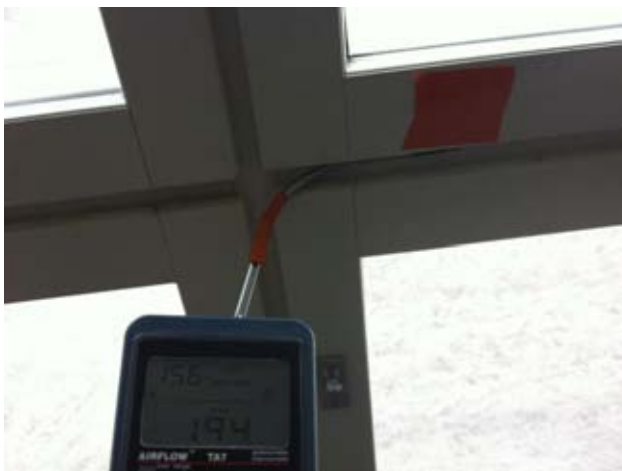
Kuvat 98-101: Ilmanvuoja ikkunaelementin karmin ja puitteiden välistä (33)
