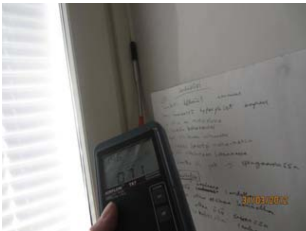
Kuvat 58-61: Ilmanvuotoja ikkunan karmin liitoksesta seinärakenteeseen (22)
