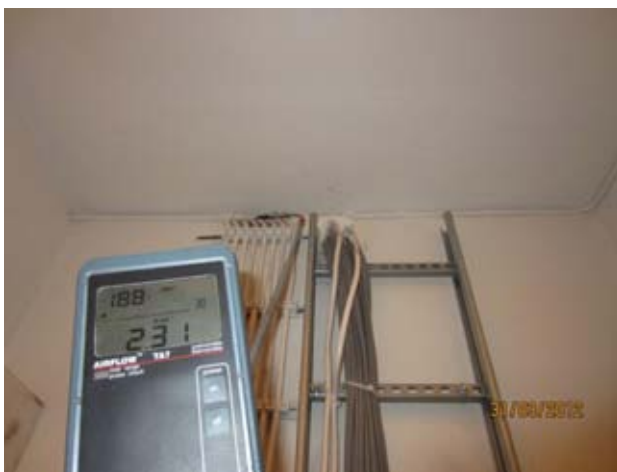
Kuvat 5-8: Ilmanvuotoja sähkökaapeleiden läpivienneistä (3)
