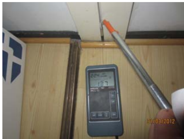
Kuvat 67 ja 68: Ilmanvuotoja kellarikäynnin vastaisen seinän ja lattiapäällysteen rajalla, havaittu myös savun avulla (25)
