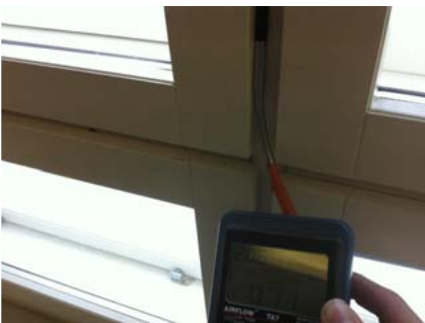
Kuvat 48-51: Ilmanvuotoja välikarmin ja puitteiden välistä (16)
