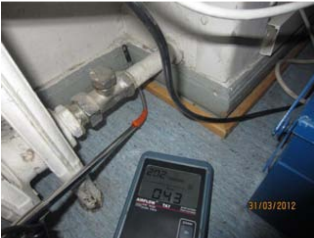
Kuvat 7-10: Ilmanvuotoja jalkalistan takaa patterisyyvennyksessä (3)
