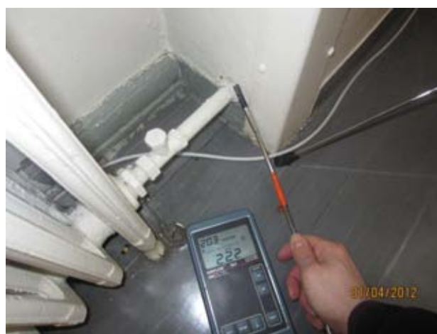
Kuvat 13 ja 14: Ilmanvuotoja patterin vesiputken ja ulkoseinän liitoksesta (5)
