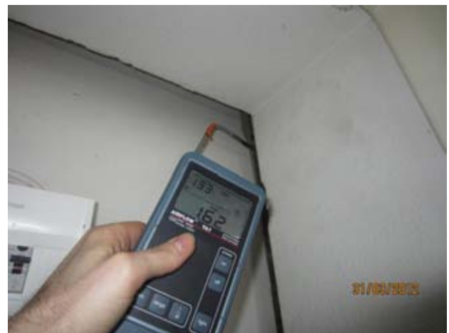
Kuvat 77-83: Laajoja ilmanvuotoja sähkökeskuksen takaseinän ja kantavan seinän välistä (27)
