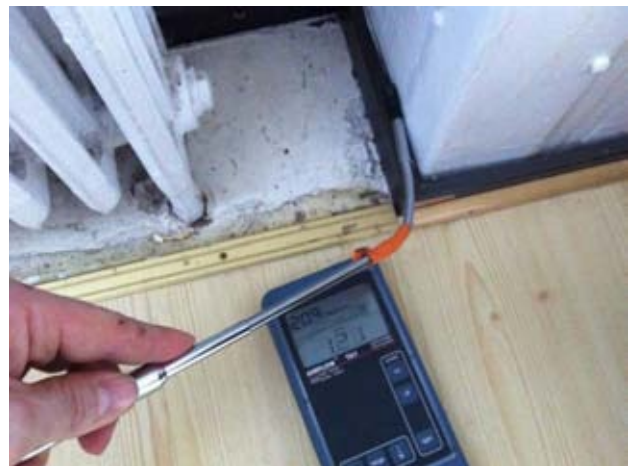
Kuvat 74-77: Ilmanvuotoja ulkoseinän liitoksesta kellarin vastaiseen välipohjaan jalkalistan takaa (24)
