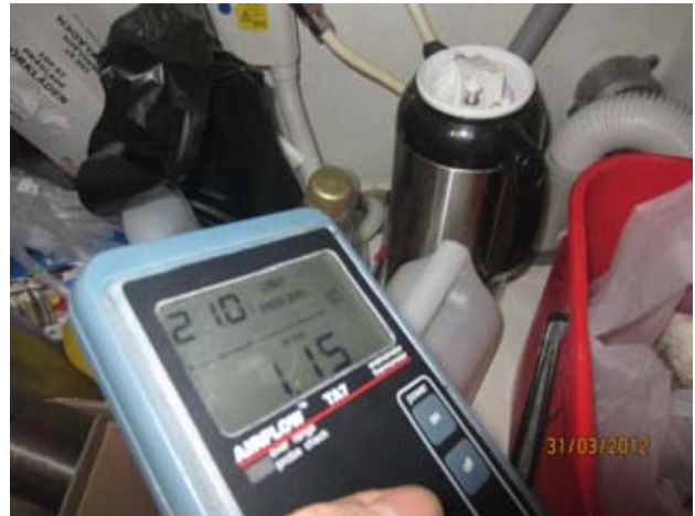
Kuvat 62 ja 63: Ilmanvuotoja allaskaapin pohjalevyssä olevasta reiästä (23)
