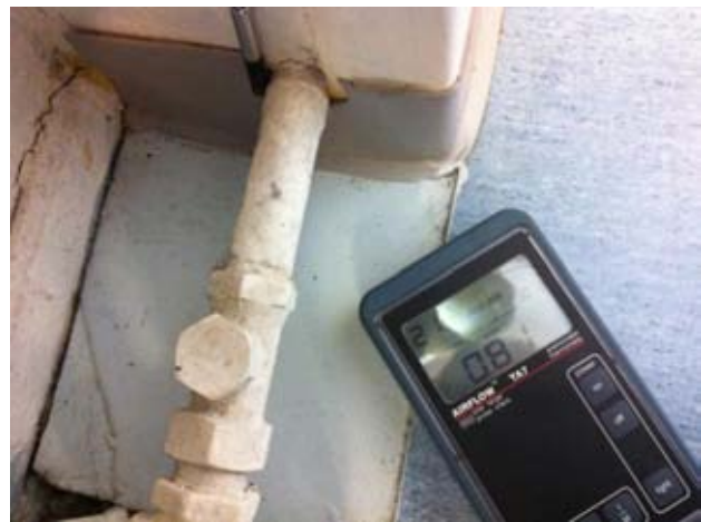
Kuvat 57-60: Ilmanvuoja ulkoseinän ja kellarin vastaisen välipohjan liitoksesta patterisyvennyksessä (19)
