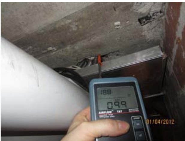
Kuvat 15-18: Ilmanvuotoja välipohjan läpiviennistä sähköjohtoja varten (5)
