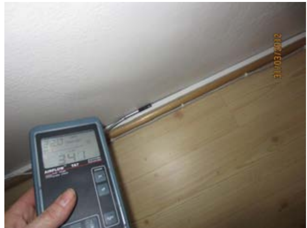
Kuvat 79 ja 80: Ilmanvuotoja WC:n vastaisen seinän ja lattian liitoksesta, havaittu myös savun avulla (31)
