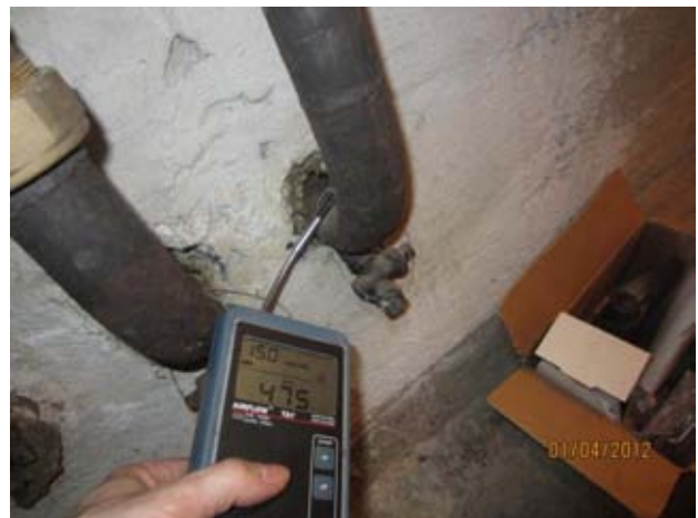
Kuvat 6 ja 7: Ilmanvuotoja puutteellisesti tiivistetystä ulkoseinän läpiviennistä (3)
