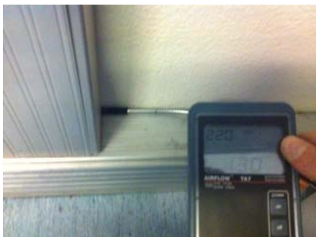
Kuvat 41-44: Ilmanvuotoja johtokotelosta, havaittu myös savun avulla (14)
