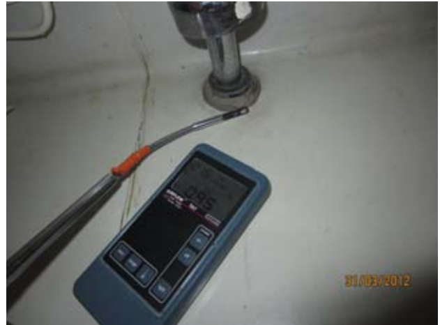
Kuvat 56 ja 57: Ilmanvuotoja välipohjan läpiviennistä viemäriä varten (20)
