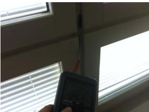
Kuvat 38-41: Ilmanvuotoja ikkunan pystyvälikarmin ja puitteen välistä (13)
