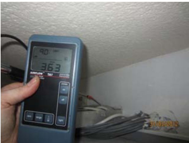
Kuvat 65-70: Ilmanvuotoja seinän läpivienneistä kaapeleita varten (24)
