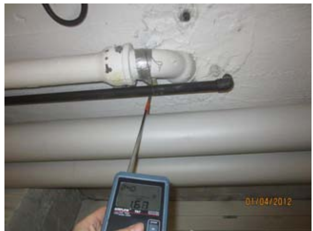
Kuvat 23-26: Ilmanvuotoja välipohjan läpiviennistä viemäriä varten sekä välipohjan betonissa olevasta reiästä (7)
