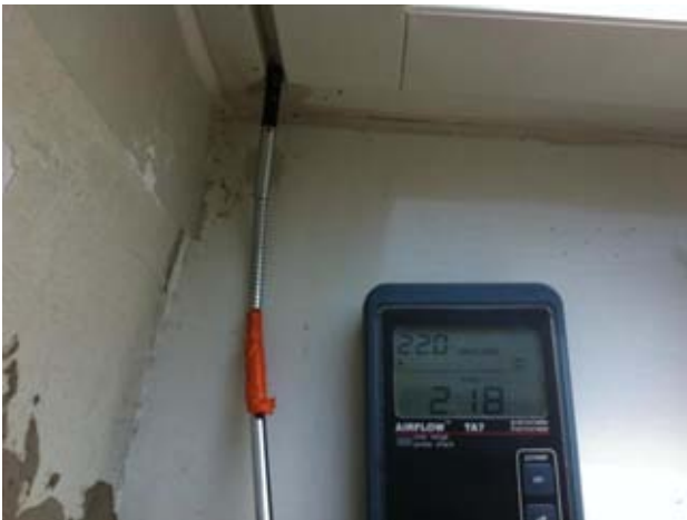
Kuvat 30-33: Ilmanvuotoja ikkunan liitoksesta seinärakenteeseen (10)
