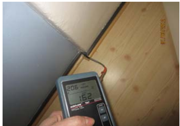
Kuvat 75 ja 76: Ilmanvuotoja väliseinän ja lattiapäällysteen liitoksesta, havaittu myös savun avulla (29)
