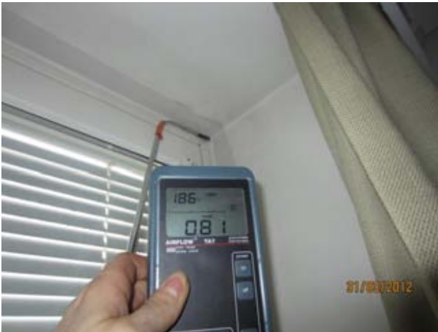
Kuvat 71-74: Ilmanvuotoja ikkunan karmin liitoksesta seinärakenteeseen (25)
