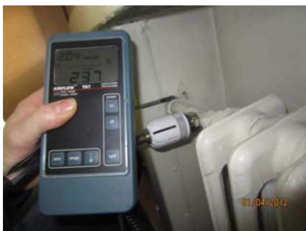
Kuvat 15-19: Ilmanvuotoja patterin vesiputkien ja ulkoseinän liitoksesta (6)
