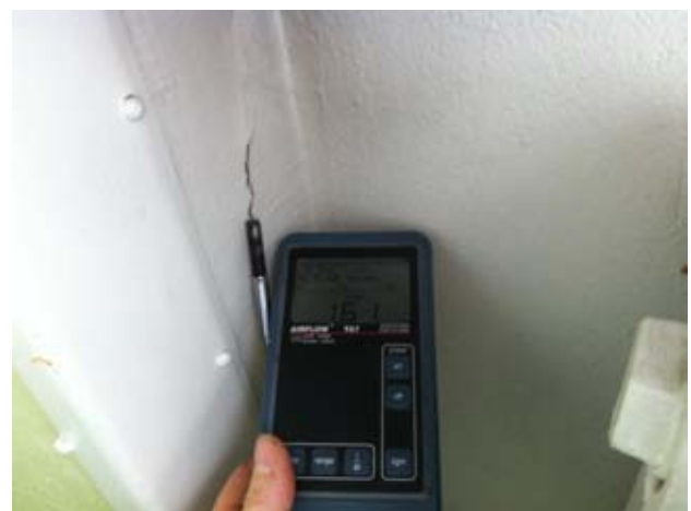
Kuvat 34 ja 35: Ilmanvuotoja patterisivyennyksen sivuseinässä olevasta halkeamasta (11)
