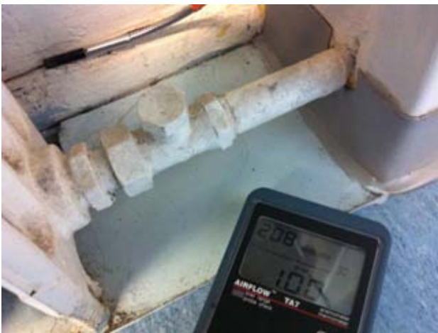
Kuvat 57-60: Ilmanvuoja ulkoseinän ja kellarin vastaisen välipohjan liitoksesta patterisyvennyksessä (19)
