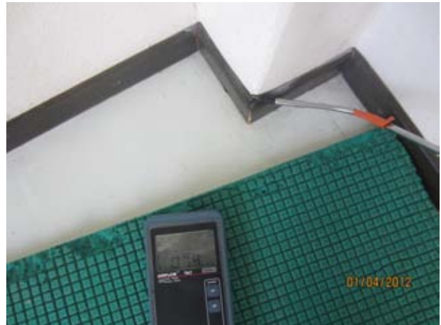
Kuvat 73 ja 74: Ilmanvuotoja kantavan pilarin ja välipohjan liitoksesta (25)
