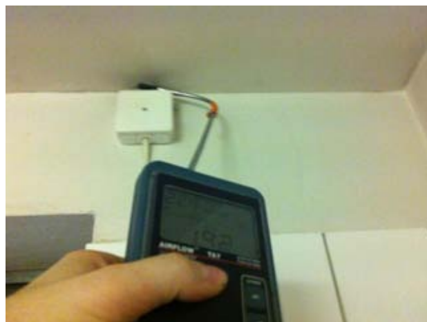
Kuvat 86 ja 87: Ilmanvuotoja alasasketussa katossa olevasta läpiviennistä sähköasennusta varten (28)
