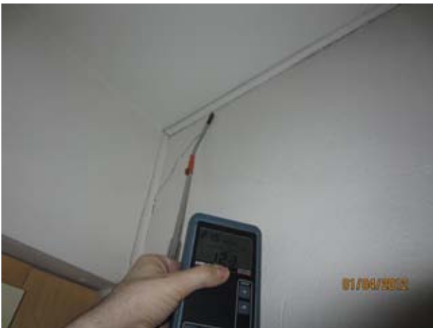
Kuvat 42-45: Ilmanvuotoja ulkoseinässä olevasta halkeamasta (17)
