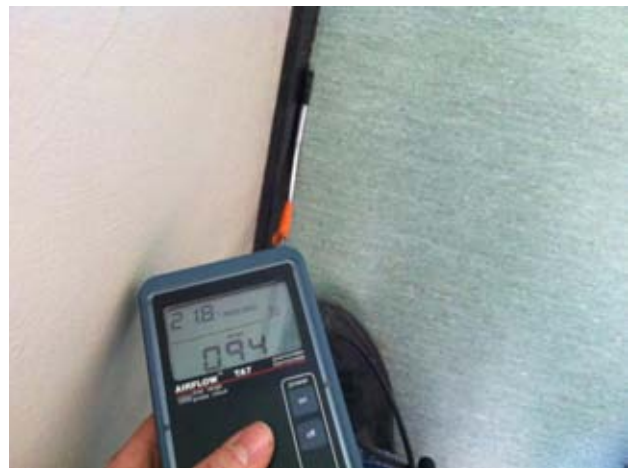
Kuvat 94 ja 95: Ilmanvuotoja ulkoseinän ja kellarin vastaisen välipohjan liitoksesta jalkalistan takaa (31)
