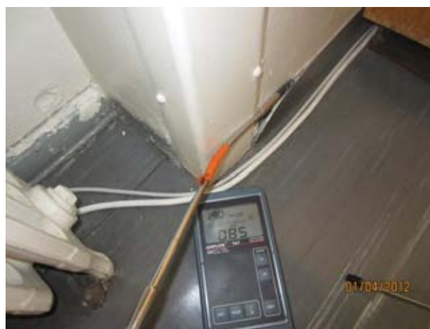
Kuvat 9-12: Ilmanvuotoja ulkoseinän ja välipohjan liitoksesta patterisyvennyksen kohdalla (4)
