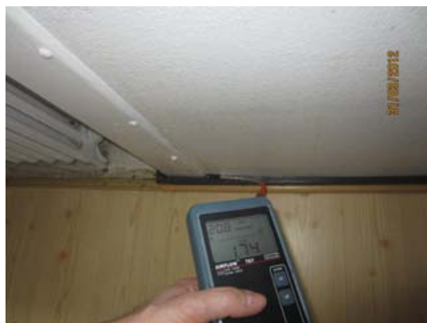
Kuvat 60 ja 61: Ilmanvuotoja ulkoseinän ja lattiapäällysteen liitoksesta, havaittu myös savun avulla (22)
