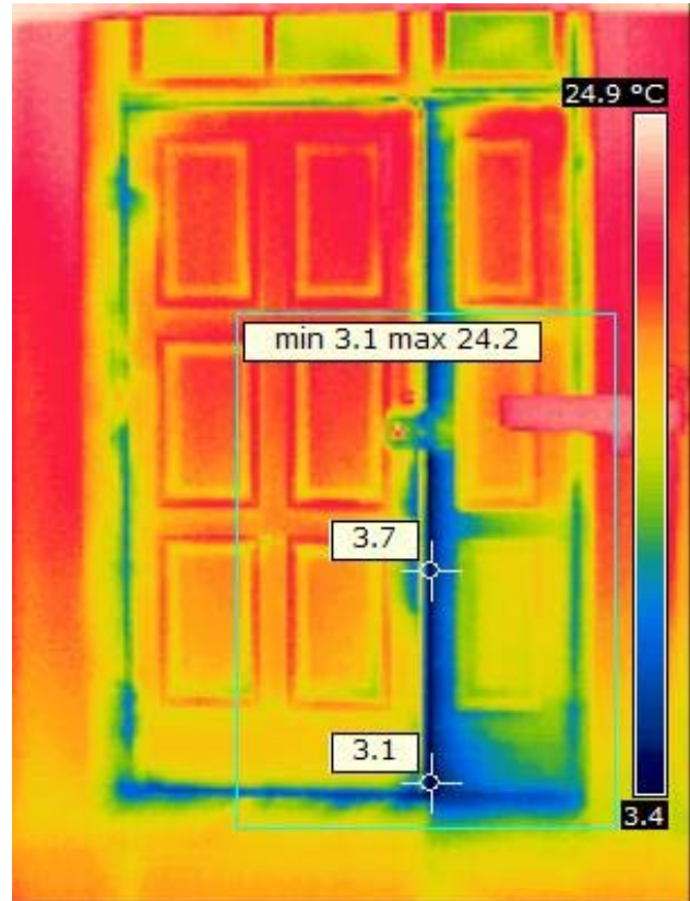
Kuvat 24 ja 25: Ilmanvuotoja ulko-oven ovilehden ja levikeosan välistä (10)
