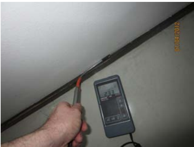
Kuvat 50-53: Ilmanvuotoja ulkoseinän ja välipohjan liitoksesta (17)
