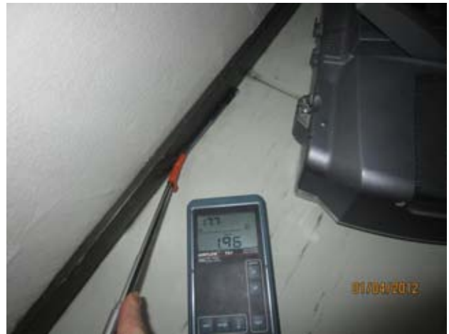
Kuvat 61-64: Laajoja ilmanvutoja päätyseinän ja välipohjan liitoksesta (21)
