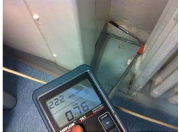
Kuvat 54 ja 55: Ilmanvuotoja ulkoseinän ja lattian liitoksesta patterisyvennyksestä, havaittu myös savua (19)
