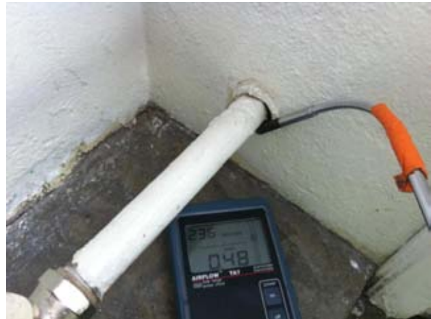
Kuvat 36 ja 37: Ilmanvuotoja seinän läpiviennistä patterin vesiputkea varten (12)
