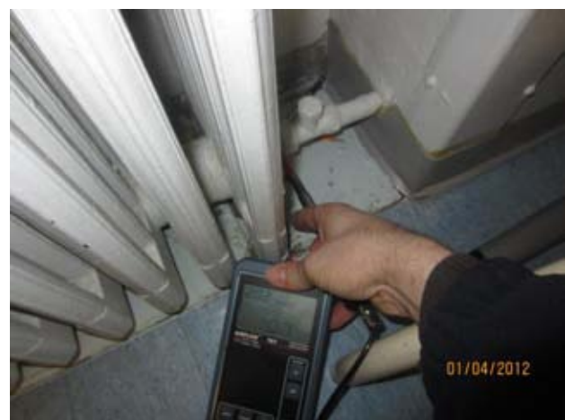
Kuvat 34 ja 35: Ilmanvuotoja patterisyyvennyksessä välipohjan ja ulkoseinän liitoksesta (11)
