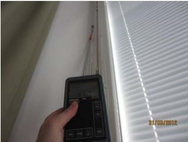
Kuvat 42-45: Ilmanvuotoja ikkunan karmin liitoksesta seinärakenteeseen (17)
