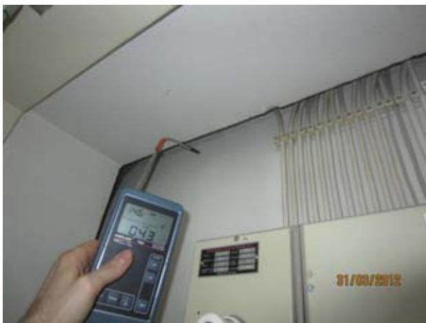
Kuvat 77-83: Laajoja ilmanvuotoja sähkökeskuksen takaseinän ja kantavan seinän välistä (27)
