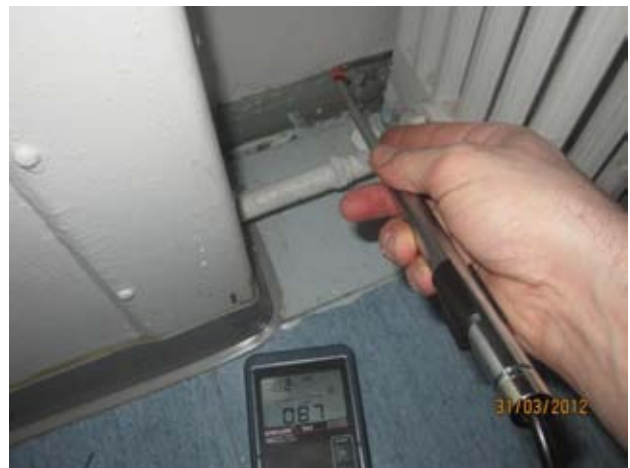
Kuvat 75 ja 76: Ilmanvuotoja patterisyvennyksessä välipohjan ja ulkoseinän liitoksesta jalkalistan takaa (26)
