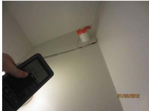
Kuvat 1 ja 2: Ilmanvuotoja IV-venttiilin kehyksen ja seinän liitoksesta (1)
