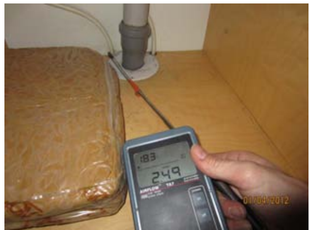
Kuvat 65 ja 66: Ilmanvutoja kaapin pohjalevyssä olevista läpivienneistä (22)
