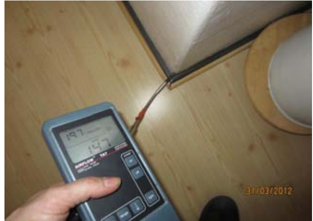
Kuvat 73 ja 74: Ilmanvuotoja väliseinän ja lattiapäällysteen liitoksesta, havaittu myös savun avulla (28)
