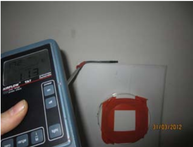
Kuvat 107-110: Ilmanvuotoja IV-venttiilien asennuslevyn takaa (36)
