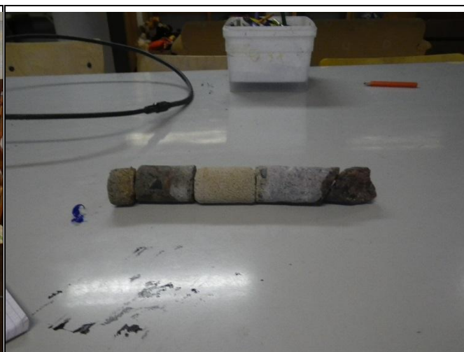
Kuva 8.3 Lattiarakenne on yli 500 mm paksu
