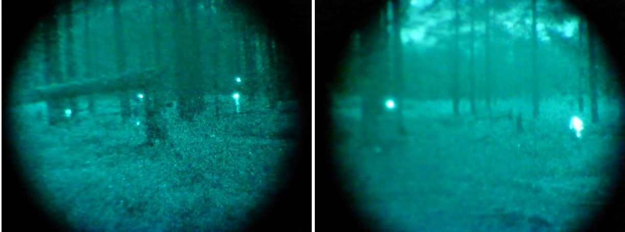
Kuva 5. Kaksi rekonstruktiossa valonvahvistimen läpi otettua kuvaa, jossa näkyy taistelijoiden kiiluja, maaleja ja ampumasektorin merkki. Maalit ja kiilut erottuvat huomommin sivummalta katsottuna. Kuvan laatuun vaikuttavat pimeys ja valonvahvistimen säädöt. 3
