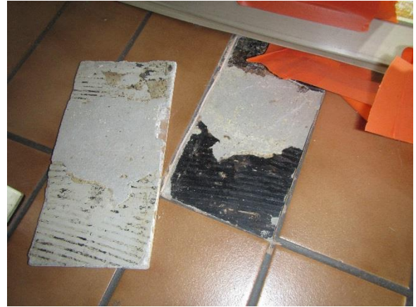
Kuva 23. Lattialaattojen kiinnityslaastin alla on asbestipitoista mustaa liimaa, näyte 51.
