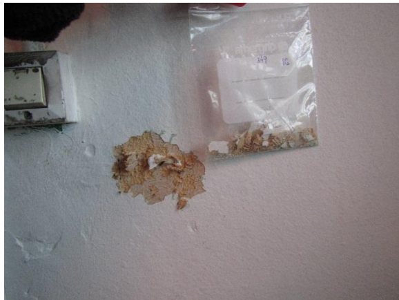
Kuva 47. Tilan 349 seinämaalit sisältävät lyijyä yli vaarallisen jätteen raja-arvon.
