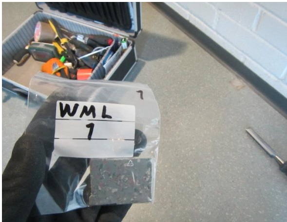
Kuva 5. Harmaa, pilkullinen linoleumimatto (WML 1) sisältää haitallisen määrän sinkkiä.
