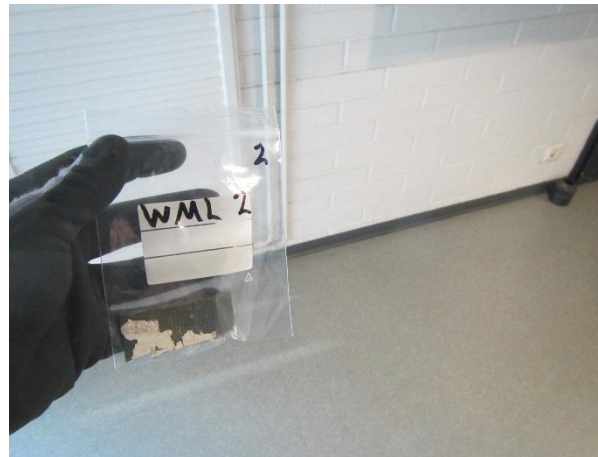
Kuva 6. Tummanharmaa lattialista (WML 2) sisältää haitallisen määrän sinkkiä.
